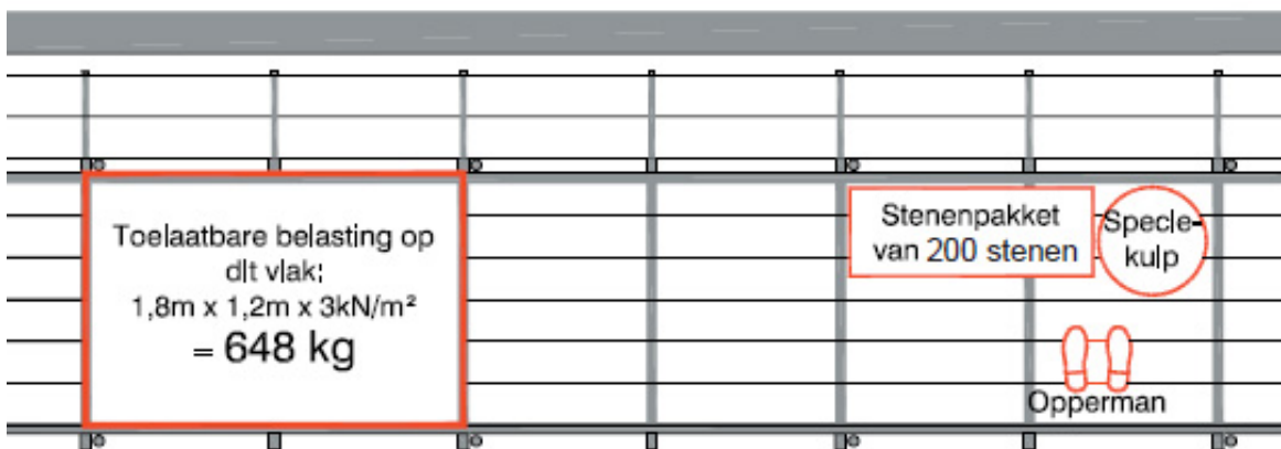
Figuur 23: voorbeeld van controle op de gekozen belastingklasse Bron: richtlijnsteigers.nl - §3.1.2
