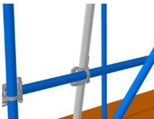
Stap 3: Zet de hulpleuning met kruiskoppelingen aan de leuning van de onderliggende vloer vast.
